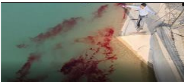
شکل ۱۷. تزریق ماده رنگی به جریان آب جهت بررسی حرکت جریان - بالادست آبگیر در مرحله بعدی
