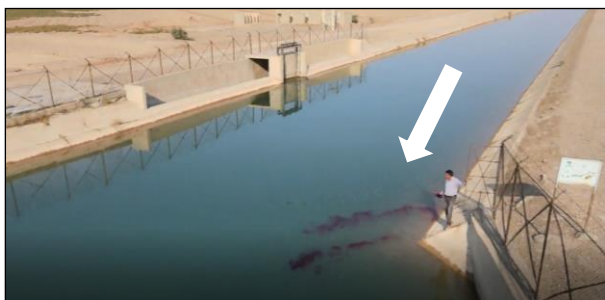
شکل ۱۶. تزریق ماده رنگی به جریان آب جهت بررسی حرکت جریان - بالادست آبگیر در مرحله ابتدایی
