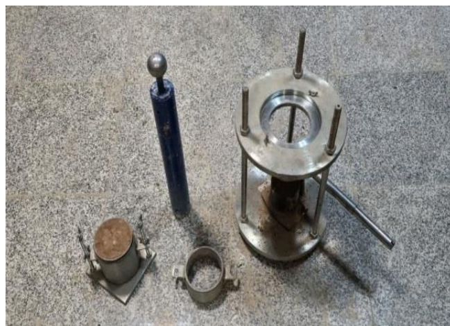
شکل ۶. تجهیزات و ابزارهای مورد استفاده در آزمایش تراکم پروکتور استاندارد (SPC)
