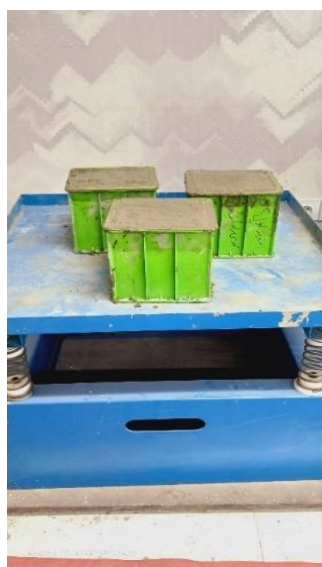
شکل ۶. جریات ساخت نمونه‌ها و تست مقاومت فشاری
