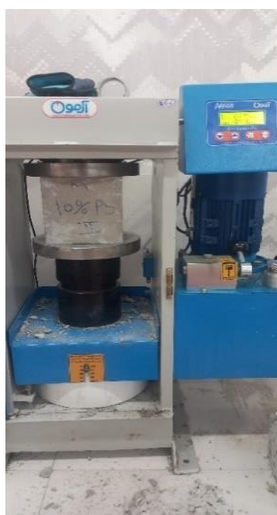
شکل ۶. جریات ساخت نمونه‌ها و تست مقاومت فشاری
