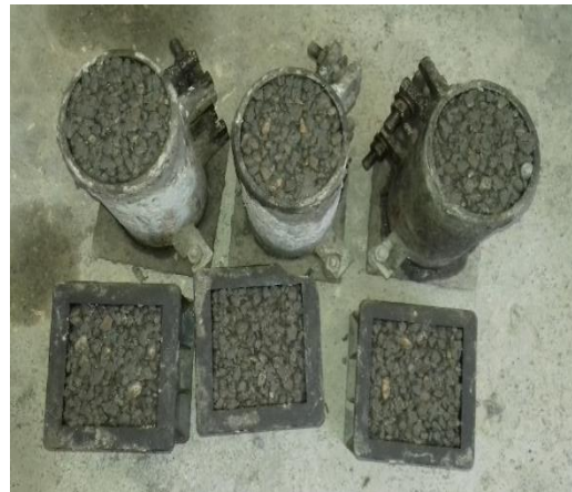
شکل ۸. عکس قالب گیری بتن
