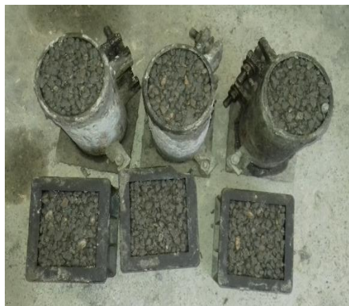
شکل ۸. عکس قالب گیری بتن
